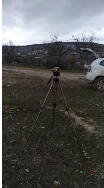
Şekil IV.22 EMJ-2 noktasında Gürültü Seviyesi Ölçümü
